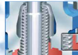
Fuelle reforzado (10.000 ciclos completos) - soldado a la parte superior del cuerpo
