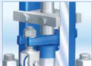
Empaquetadura con prensa, proporciona un sistema adicional de sellado del eje
